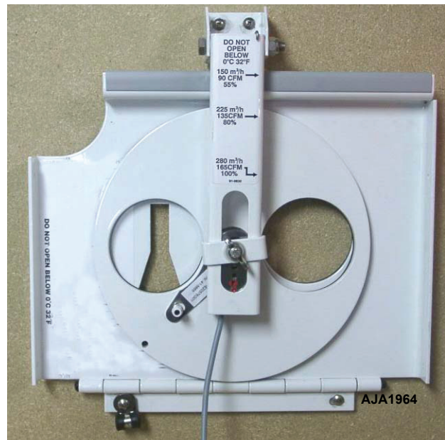
Figura 44: AVL (Registro da ventilação de ar)
